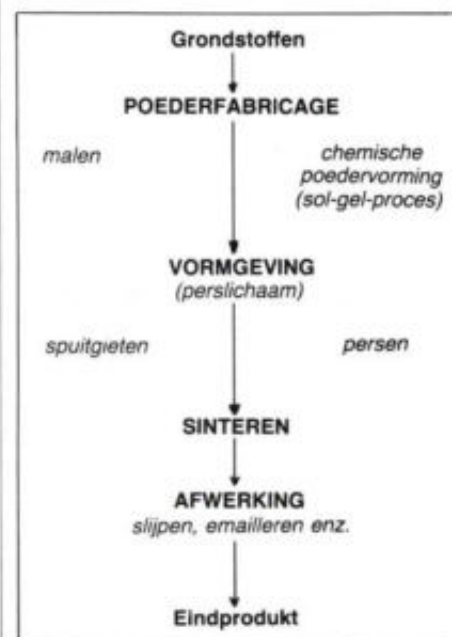
Fig. 1. Het fabricageproces van keramiek omvat drie belangrijke fasen. Eerst wordt uit de verschillende grondstoffen, door malen of door een chemisch proces, een poeder gevormd. Met pers- of spuitgiettechnieken wordt daarna het perslichaam vervaardigd, dat in een sinterven de uiteindelijke sterkte verkrijgt. Hiermee is het eigenlijke fabricageproces afgerond. Voor het verkrijgen van het eindproduct zijn nog de afwerkende behandelingen zoals slijpen of emaileren vereist.
